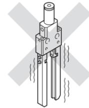
● アタッチメント(ツメ)とワークの摩擦力での把持が不安定な場合は、アタッチメント(ツメ)に落下防止用の引っかかり部を設けてください。
